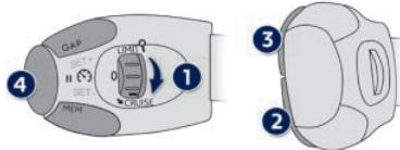
巡航功能需要手动开启，车速需要在 30 至 180km/h 之间。自动变速箱必须置于 D 挡或 M 挡。
