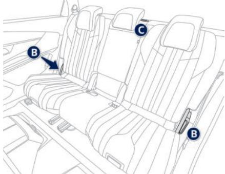
您可以通过拉动图示两侧折叠手柄 B 来对第二排座椅分别折叠。
