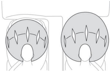
在正面发生严重碰撞时，该系统保护驾驶员和前座乘客，减少头部和胸部的受伤害的程度。驾驶员气囊安装在方向盘中间；前座乘客正面气囊位于仪表板里面。
