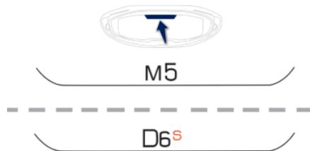
点火开关打开，变速箱挡位会显示在组合仪表上：
