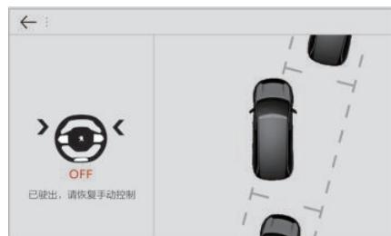
当车辆前轮驶出停车位时，平行泊车驶出结束。此时仪表板上的指示灯熄灭并伴有声音信号，显示屏出现提示信息。自动驶出已完成，恢复方向盘控制。
