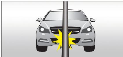
与电线杆或树木等柱状物体发生正面撞击，此时撞击能量在很大程度被车体变形所吸收，撞击减速度没有达到触发限值，气囊也不会起爆。
