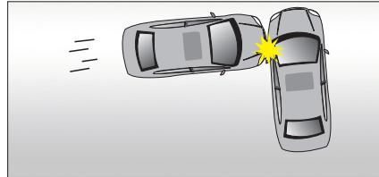
发动机舱或行李箱受到侧面撞击时，因为发动机舱、行李箱的刚度远远低于座舱的刚度，撞击时，这一部分将产生严重变形而吸收了撞击能量。此时侧面撞击的强度不足以触发侧气囊。
