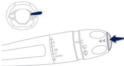
按雨刮组合开关末端的按钮，可依次显示行车电脑各项信息。
