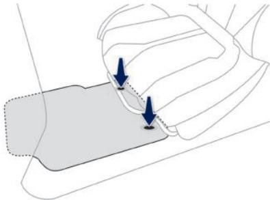
驾驶员侧的地毯上备有脚垫固定销，与带有定位孔的脚垫配套使用，可有效地防止脚垫滑动，保障驾驶安全。
