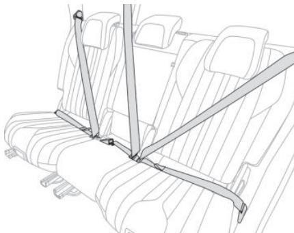
后座椅均配备为 3 点式惯性卷收器安全带。两侧的安全带带有预张紧及限力装置。
