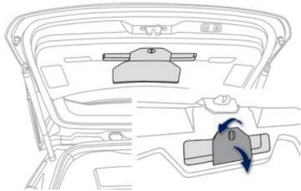
三角警告牌存放在后尾门内饰板上。开启后尾门，逆时针转动保护盖来取出三角警告牌。
