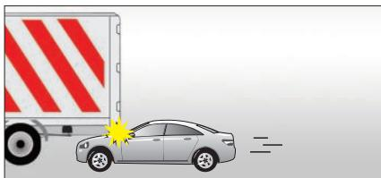
小车钻入货柜车或大型车辆下部，气囊不易起爆一般是因为撞击减速度没有达到规定值。
