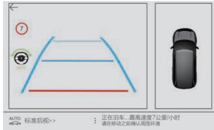
☞ 自动泊车进行中。控制车速低于 7 公里 / 小时，根据驻车辅助功能的警示声音换挡前进或倒车，直至出现泊车完成的提示。
