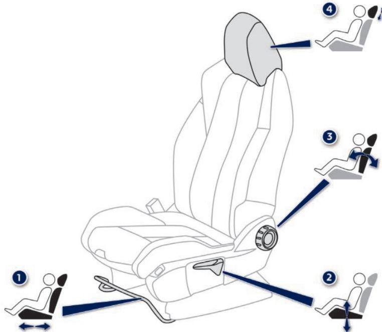
! 在调节座椅向后滑动时，避免可能由后排乘客或地板上的障碍物所导致的滑轨阻塞带来的风险，确保座椅滑动没有受到阻碍。如果座椅滑动受阻，请立即停止操作并检查。
