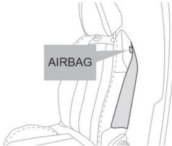
在车辆受到严重的侧面撞击时，侧气囊能保护驾驶员及前排乘员，最大程度减少对其胸部和腰腹部的伤害。每个侧气囊都安装在座椅靠背上，靠近车门一侧。
