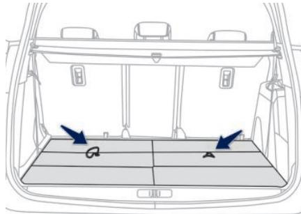
**i** 当第三排座椅折叠放置，折叠板平铺放置在第三排座椅上时，折叠板可以承重 100kg。
