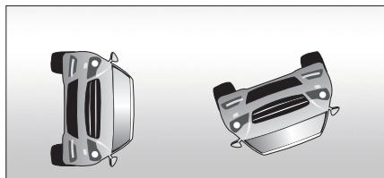
车辆侧翻或侧翻滚时，系统传感器探测的减速度方向与车辆侧翻滚方向不一致，气囊也不会起爆。
