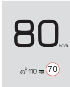
当探测到限速牌，系统会显示限速车速值并提示可将其存储为一个新的车速记忆值。“MEM”提示会在屏幕上闪烁几秒钟。
