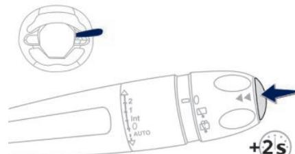
当显示需要的行程信息时，将雨刮组合开关末端按键按住2秒钟以上进行归零。
