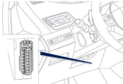
诊断接口位于方向盘下方饰板内，拆下饰板可见，您可以使用符合 OBD 标准的诊断工具（如：元征 X431 等）通过诊断接口来读取车辆 VIN 信息，操作过程中如有疑问请与东风标致授权销售服务商进行联系。
