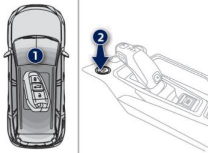
电子钥匙位于车内，不踩下制动踏板，按压“START/STOP”按键，可以接通点火开关以启动附件电源（如音响系统、灯光……）。
