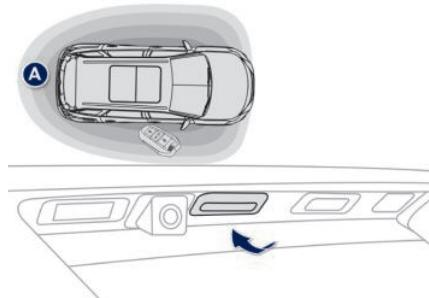
**i** 如果一个车门或行李箱开启或电子钥匙遗留在车内，中控锁将不起作用。尽管如此，防盗报警器仍然在约 45 秒后完全激活。
