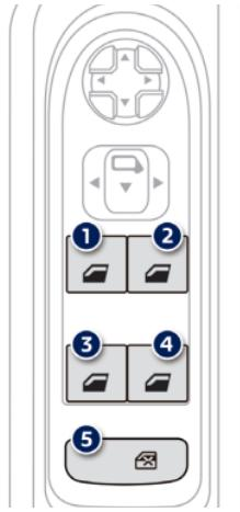
接通点火开关后，驾驶员一侧车门上的控制键可控制 4 个车门的玻璃电动升降。
