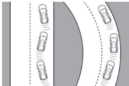
除了具有驾驶时间警告外，系统还能借助前挡风玻璃上方的摄像头，来比对车辆的轨迹与车道标识线来评估驾驶员的注意力等级。本系统尤其适合在高速行驶时使用（车速大于 65km/h）。
