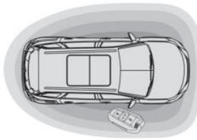
将电子钥匙随身携带，在限定的区域内即可解锁、锁止车门或起动车辆，同时电子钥匙也含有遥控器功能。
