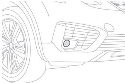
在车辆进入弯道时，本系统可以利用相应的雾灯进行辅助照明，车辆的大灯必须点亮并且车速低于 40km/h。
