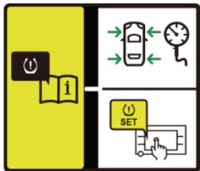
每次调整轮胎气压或更换轮胎之后，需要进行胎压标定以初始化胎压监测系统。轮胎气压标签位于驾驶员侧的中立柱上。
