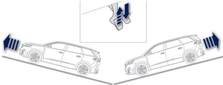
**!** 坡道起步辅助维持车辆不动的短时间内，请不要下车。如果发动机运转时您需要下车，请拉紧驻车制动，并确认驻车制动指示灯（和电子驻车的制动开关指示灯）为常亮状态。
