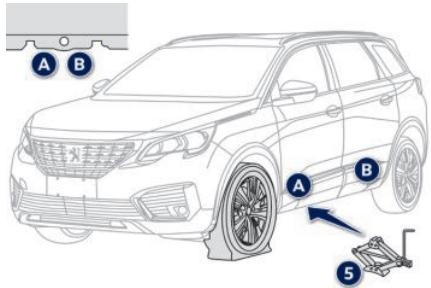
☞ 将千斤顶放置在离待更换车轮最近的车身下边梁的支点 A 或 B 处。
