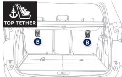
两个固定环 B 在座椅靠背后，带有“TOP TETHER”标识。
