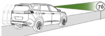
通过前挡风玻璃上方的摄像头来探测道路的限速与限速解除标识。系统也可以通过导航地图来获取相关信息。
