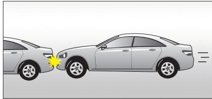
行驶中您的车辆对其他车辆追尾时，尽管事故前车速很高，但与被追尾车辆相对速度可能不高。另外被追尾车辆不是不可变形的、不可移动的刚性障碍物，它可以吸收撞击能量。气囊不起爆原因主要是撞击减速度没有达到触发限值。
