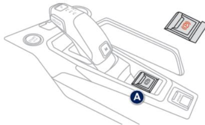
如果车辆主制动系统发生了故障或在异常情况下（例如驾驶员生病等），持续拉动控制开关 A 将停止车辆。电子稳定程序（ESP）提供动态紧急制动期间的稳定性。如果动态紧急制动发生故障，显示屏会显示“驻车制动故障”信息。
