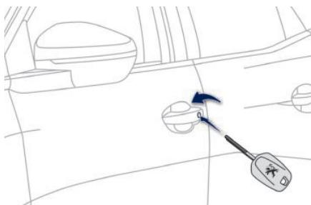
将钥匙向车头方向转动，解锁所有车门。
