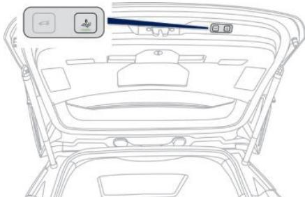
可以通过电动尾门感应方式在关闭尾门时激活车辆自动锁止功能。
