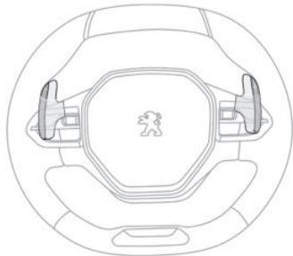
当处于手动模式 M 挡时，可以通过方向盘上的换挡拨片进行手动换挡。
