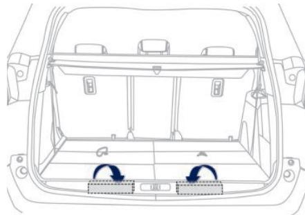
部分工具放置在第三排座椅后的隔板内，您可以打开后备箱，折好折叠板，安放好第三排座椅后将工具取出。
