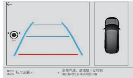
☞ 自动控制结束时，按键上的指示灯熄灭，伴随着声音信号和触控屏上的提示信息。自动泊车已完成，恢复方向盘控制。
