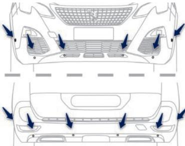
凭借保险杠上的多个传感器，该功能可探测到传感器附近的障碍物( 人员、车辆、树木、栅栏 ..... )。由于存在盲区，驻车开始时检测到的某些类型障碍物 ( 树桩、路障 ..... ) 在驻车过程中可能不会被探测到。
