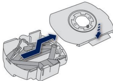
更换备胎工具盒放置在车辆下方的备胎中，千斤顶及轮胎装饰盖拆装工具置于其中。
