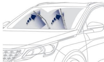
☞ 向内拉动雨刮控制杆，前挡风玻璃会进行清洗并且雨刮会运行一段时间。
