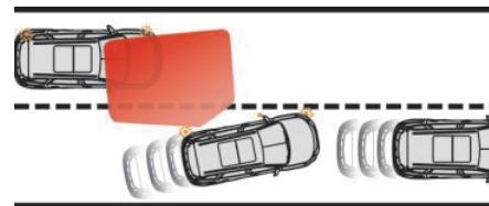
转向灯开启以及关闭转向灯之后的几秒钟内，系统会认为车辆的变道为驾驶员主观行为，系统在此期间不会触发任何纠正车辆轨迹的行为。不过当“盲区探测”功能开启，如果驾驶员准备变道但另一辆车被探测到出现在本车的盲区内时，尽管转向指示灯已经开启，系统仍然会纠正车辆的轨迹。更多的信息请参阅“盲区探测系统”相关章节。
