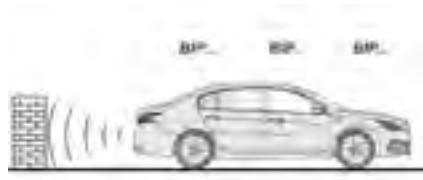
凭借保险杠上的多个传感器，该功能可探测到传感器附近的障碍物（人员、车辆、树木、栅栏...）。由于存在盲区，驻车开始时检测到的某些类型障碍物（树桩、路障...）在驻车过程中可能不会被探测到。
