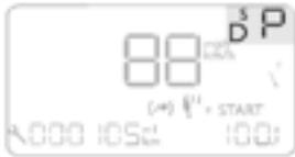
点火开关打开，变速箱挡位会显示在组合仪表上：
