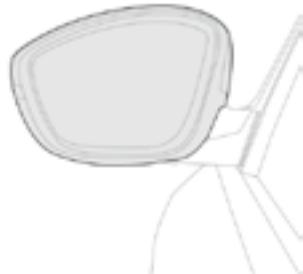
每个后视镜带有可调节的镜片，用以保证超车或停车时所必需的侧后方视野。后视镜也可折叠，保证在狭窄的空间内可以驻车。
