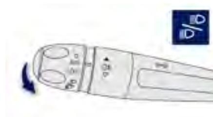
将组合开关手柄向垂直于方向盘平面方向拉动，可在近光灯和远光灯之间转换。
