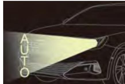
车辆静止时，系统会根据车内的负载自动调节 LED 大灯光束的高度。
