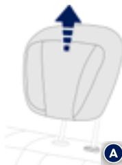
后头枕有 1 个高位（保证舒适性和安全性）和 1 个低位（保证后部视野）。后排座椅头枕同样可拆卸。
