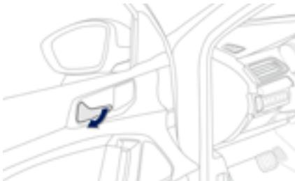
拉开车门开启手柄可打开车门，此动作将解锁车辆。
