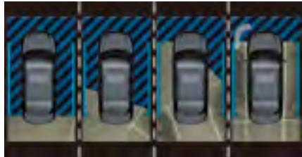
通过一个或所有的摄像头，系统在车辆操作期间记录着车辆周边环境。多功能显示屏上会出现附带车辆周边环境的俯视图（蓝色指示框内），并且视图会根据车辆的移动进行变化。此种显示有利于您在停车时看清周边的障碍物，以及更好地对齐停车位。当车辆长时间保持静止的时候此视角会从屏幕上消失。
