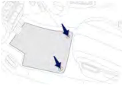
驾驶员侧的地毯上备有脚垫固定销，与带有定位孔的脚垫配套使用，可有效地防止脚垫滑动，保障驾驶安全。
