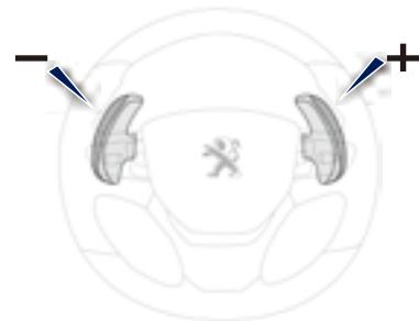
当处于手动模式 M 挡时，可以通过方向盘上的换挡拨片进行手动换挡。
