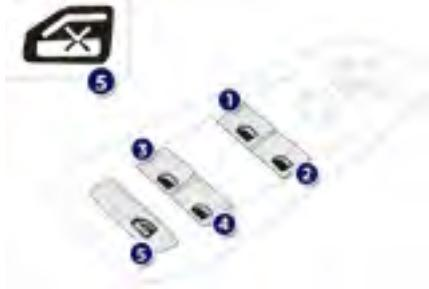
接通点火开关后，驾驶员一侧车门上的控制键可控制 4 个车门的玻璃电动升降。
