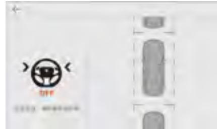
自动控制结束时，按键上的指示灯熄灭，伴随着声音信号和触控屏上的提示信息。自动泊车已完成，恢复方向盘控制。
