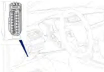
诊断接口位于方向盘下方饰板内，拆下饰板可见，您可以使用符合 OBD 标准的诊断工具（如：元征 X431 等）通过诊断接口来读取车辆 VIN 信息，操作过程中如有疑问请与东风标致授权销售服务商进行联系。
