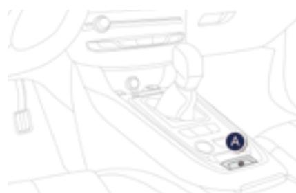
如果车辆主制动系统发生了故障或在异常情况下（例如驾驶员生病等），持续拉动控制开关 A 将停止车辆。
