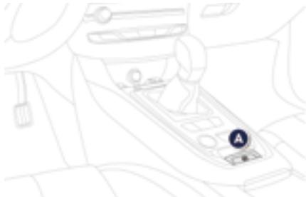
车辆停稳后，发动机运转或关闭时均可拉动控制开关 A 启用驻车制动。
