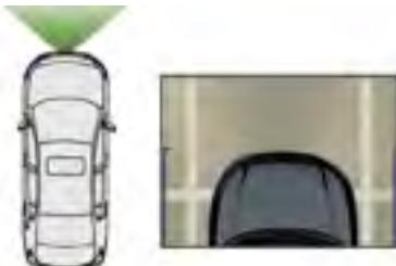
摄像头在车辆移动时记录车辆周围环境的图像，合成车辆前部俯视图，以方便看到车辆周围的障碍物。此视图可以在屏幕中单独选择也可以在 AUTO 自动模式中获得。
