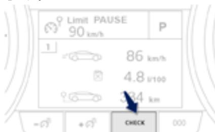
短按组合仪表上的“CHECK”键，开始手动检查（车辆自检）。
